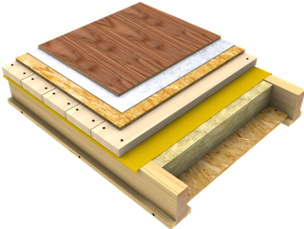
Деревянные перекрытия состоят из балок, межбалочного заполнения, звуко- и теплоизоляционного слоя, покрытия пола – плитки, ламината, паркета, линолеума.
