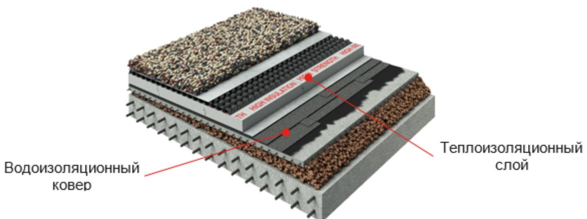
При этом следует учитывать, что **в инверсионной крыше не допускается механическое закрепление теплоизоляции к основанию**, по причине повреждения в этом случае водоизоляционного ковра.
