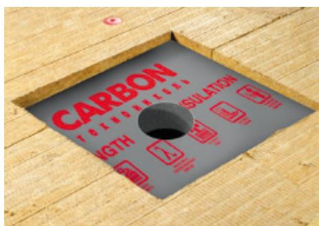
**ВАЖНО!** Для создания герметичного соединения приклейте XPS к пароизоляции с помощью Герметика бутилкаучукового ТЕХНОНИКОЛЬ №45. Если вы используете для вставки несколько слоев XPS, тогда необходимо приклеить плиты друг к другу с помощью герметика.
