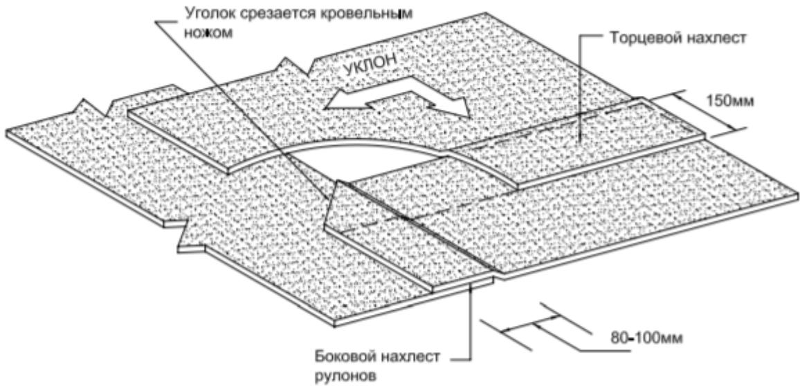
Размер уголка 150 мм в длину и 80-100 мм по ширине.
