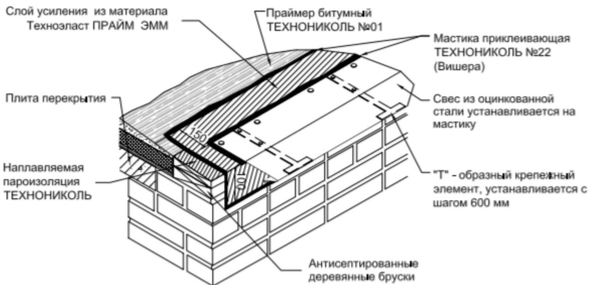
Нанесение мастики должно происходить непосредственно перед наклеиваемым рулоном. В случае если на нанесенную на основание мастику материал не был уложен в течение 5 мин, необходимо нанести дополнительный слой мастики перед приклейкой. Мастику приклеивающую ТЕХНОНИКОЛЬ №22 (Вишера) наносят по всей площади прилейки. На место бокового шва также наносят мастику. При укладке материала к основанию расход мастики составляет 1,4-1,8 кг/м<sup>2</sup>.
