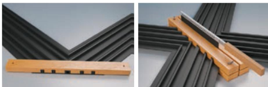
После равномерного оплавления торцов шпонок извлеките нагревательный элемент и с силой прижмите зажимы друг к другу.
