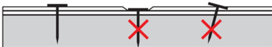
Крепить гонты гибкой черепицы нужно таким образом, чтобы вышележащий гонт дополнительно фиксировал гонт в нижележащем ряду.
