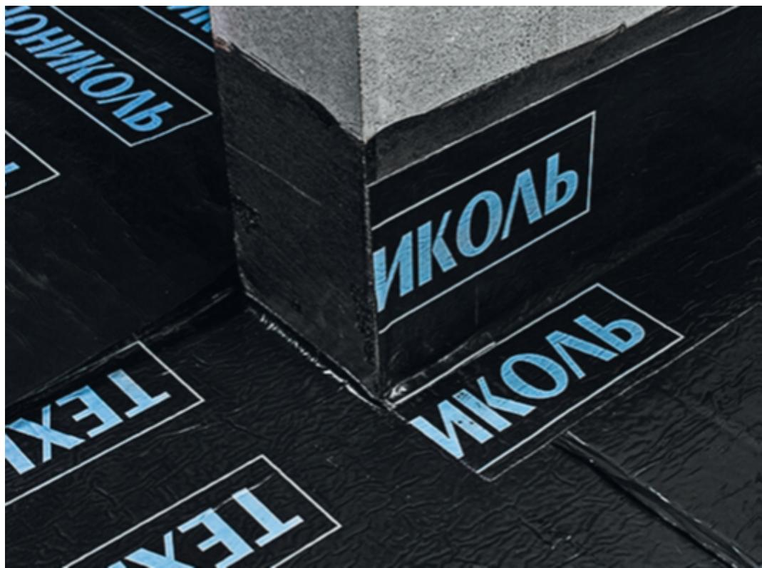
Подготовьте заплатку по всей ширине стены (перегородки). Заплатка должна заходить на две стороны стены (перегородки) и на горизонтальную часть основания на 80-100 мм.
