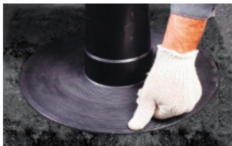
Юбку уплотнителя можно установить на предварительно разлитую на поверхность материала горячую мастику ТЕХНОНИКОЛЬ №41 («Эврика») или нанесенную шпателем герметизирующую мастику ТЕХНОНИКОЛЬ №71.
