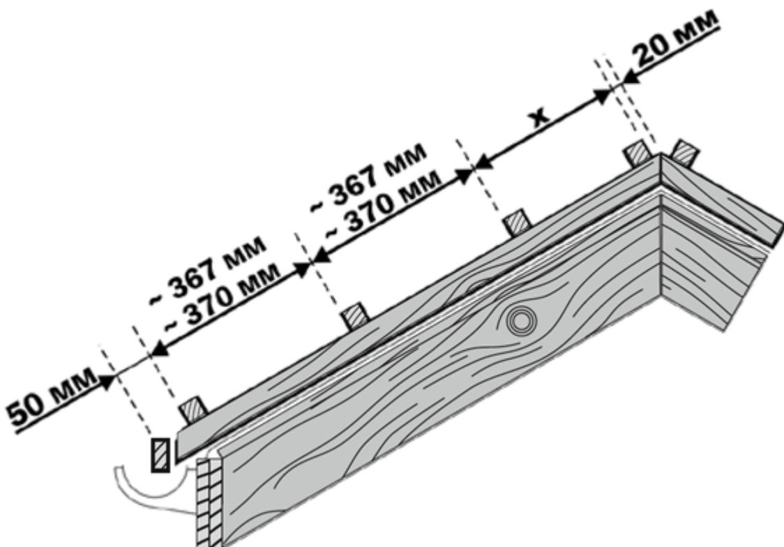
Нижний брус обрешетки механически зафиксируйте с отступом 50 мм от свеса контробрешетки.
