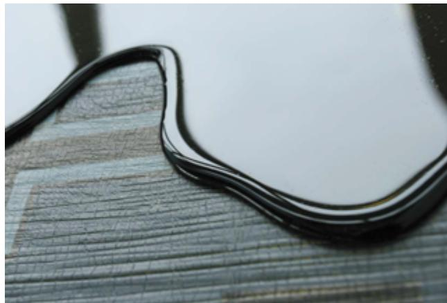
Битумные и битумно-полимерные мастики – это смесь битума, натуральных минеральных добавок и наполнителей различных размеров. На выходе получается вязкая однородная масса, которую достаточно просто наливать на плоскую поверхность. После затвердевания битумная мастика для гидроизоляции походит на монолитный материал, напоминающий по виду резину.
