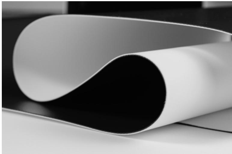
Полимерные мембранны представляют собой гидроизоляционные рулонные материалы, которые изготавливают путем соединения в единое полотно (с армирующей основой из стеклохолста или полиэфирной сетки, или без нее) слоев материала, полученных в результате экструдирования из поливинилхлорида (ПВХ мембранны) или полипропилена (ТПО мембранны) с использованием наполнителей и технологических добавок.
