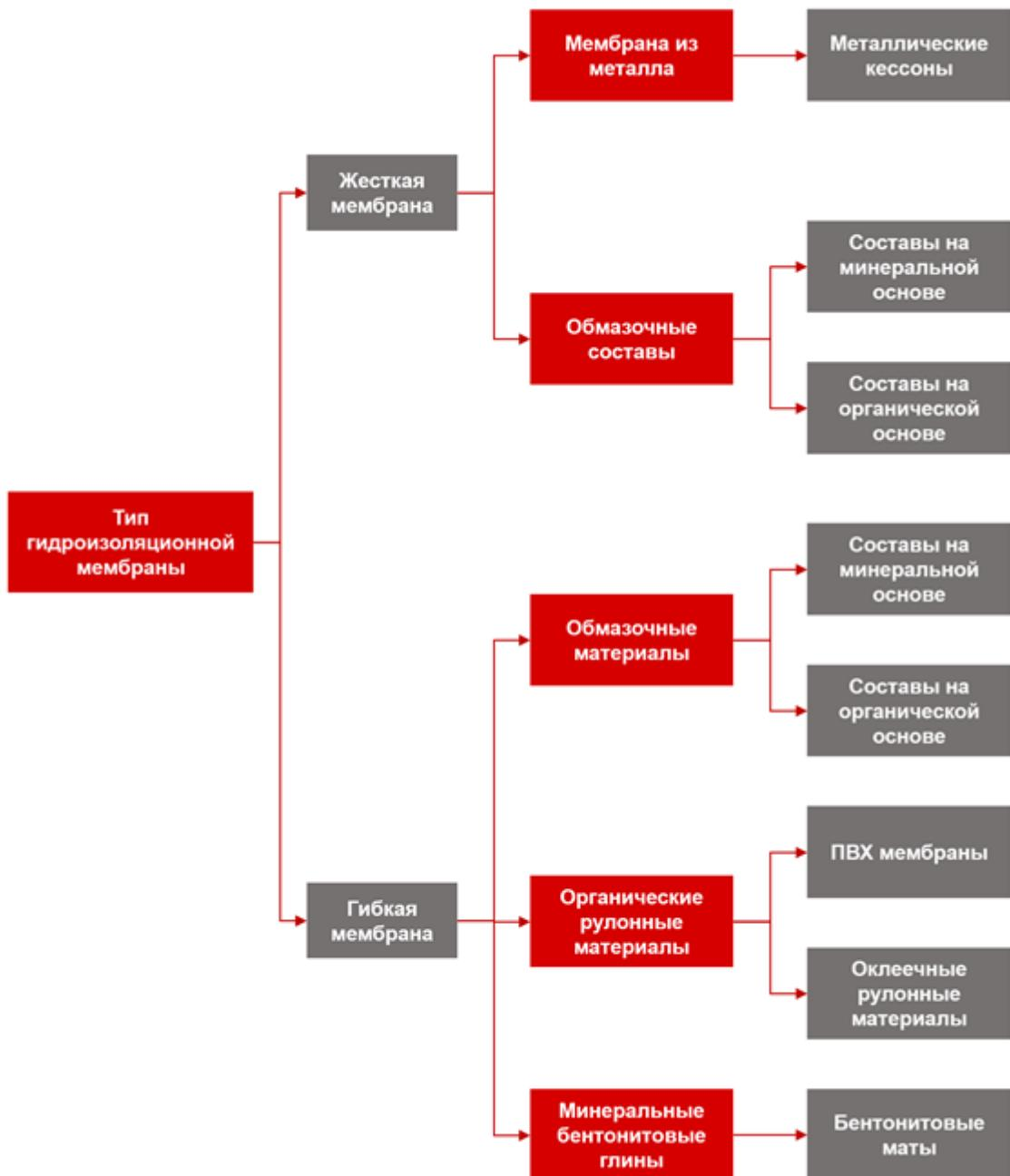
Для устройства гидроизоляционной мембраны в строительных системах ТЕХНОНИКОЛЬ для подземных частей зданий и сооружений применяются:
