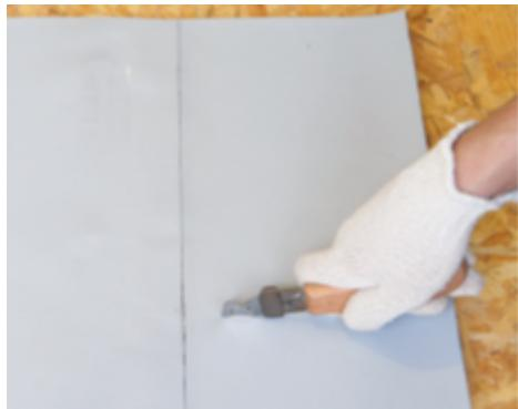
Прочность сварного шва может быть определена испытанием на разрыв вырезанного образца шва шириной **50 мм** на переносной разрывной машине типа **Leister Examto** или на стационарном оборудовании.
