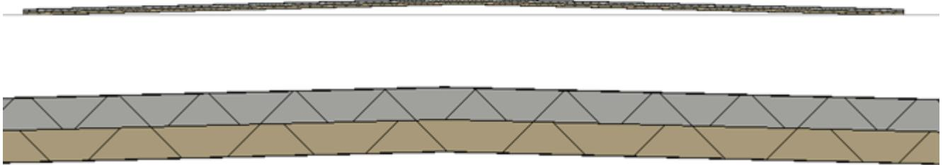
6) С помощью инструмента «КонтрУклон» создаем зоны расположения клиновидной теплоизоляции между воронками, по следующему алгоритму:
