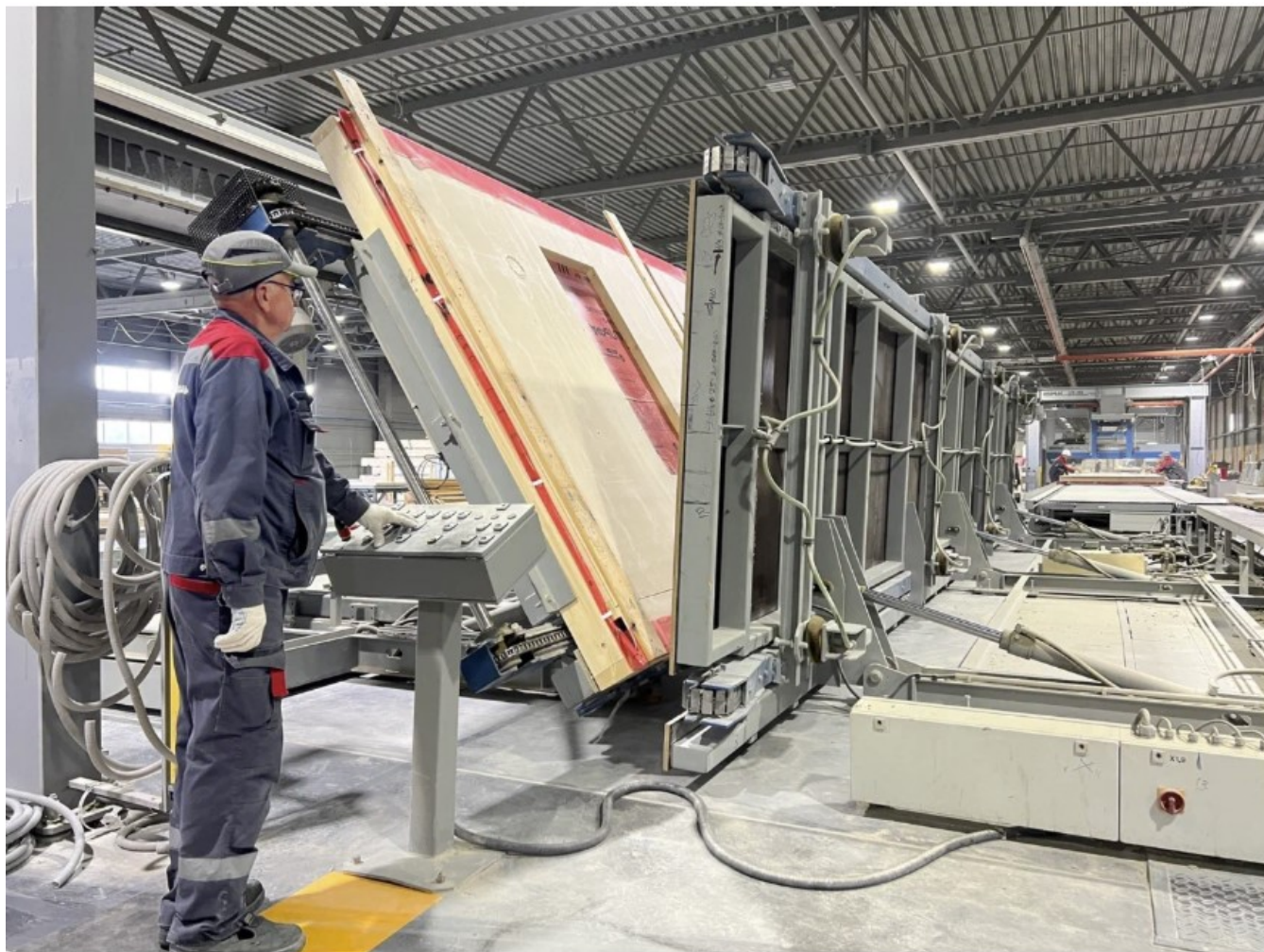
Рис. 31 Сборка стеновой панели на заводе ТЕХНОНИКОЛЬ МКД в Семенове
