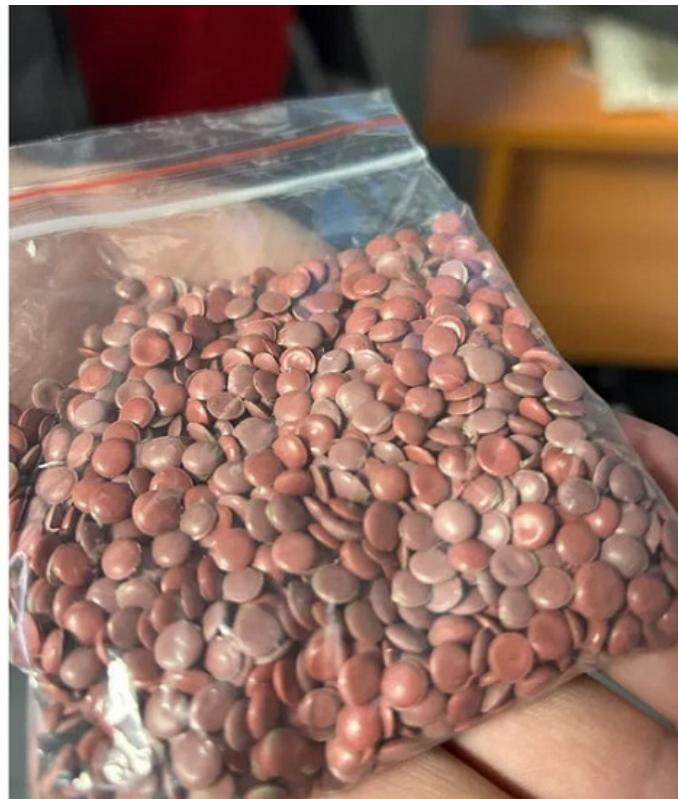
*Вторичные ПВД-гранулы из прозрачного полиэтилена и упаковочных пленок для экструзионного пенополистирола*
