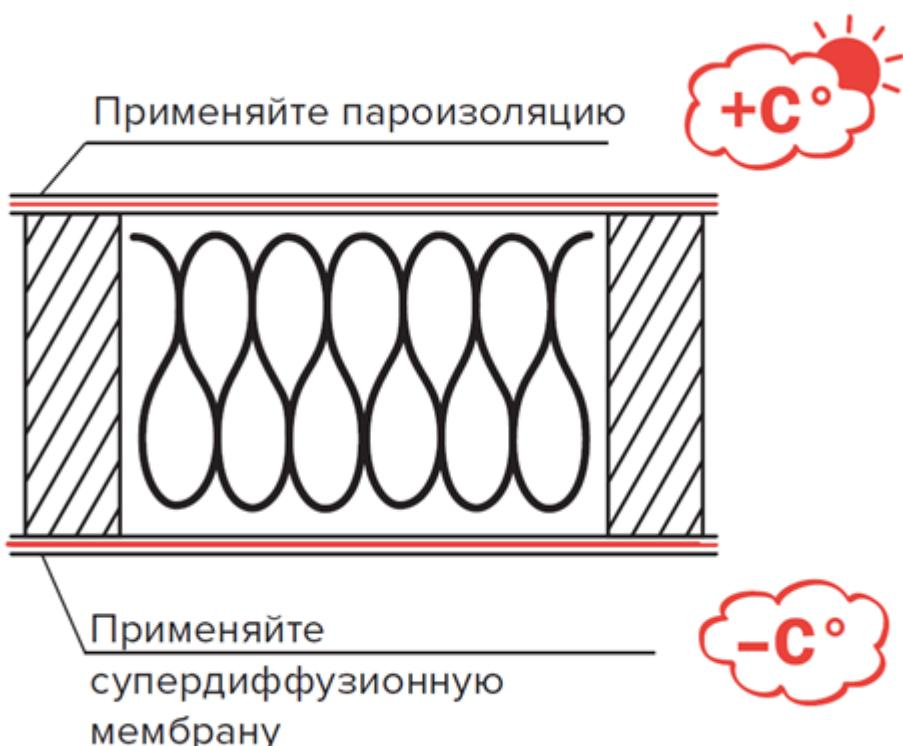
В случае утепления межэтажного перекрытия, где температура снизу и сверху одинаковая, от диффузионной мембранны можно отказаться и заменить ее пленкой с маркировкой «А», которая представляет собой полотно нетканого полипропилена (спанбонда). Т.к. отсутствует перепад температур и влажности, задача данной пленки будет заключаться в защите внутридомового пространства от проникновения волокнистого утеплителя в помещение.
