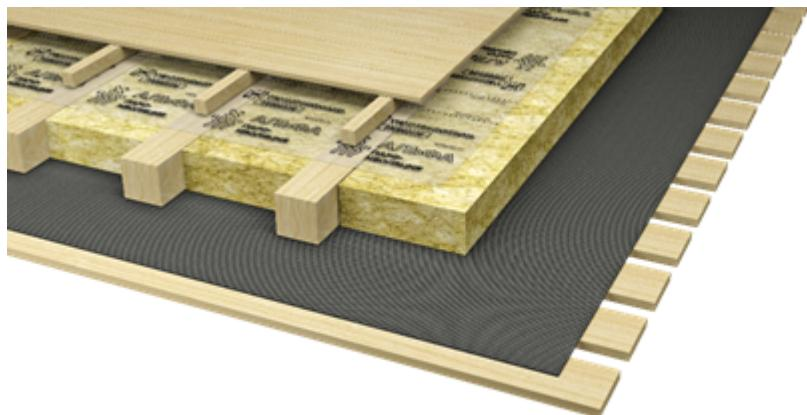
Со стороны помещения первой идет пароизоляционная пленка, далее теплоизоляция и со стороны подполья теплоизоляцию закрывает диффузионная мембрана.
