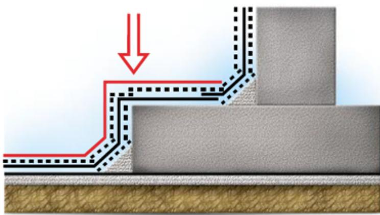
Выполните наплавление второго слоя вертикальной гидроизоляционной мембранны в зоне внешнего угла по описанной выше технологии. Сначала по фундаментной плите.
