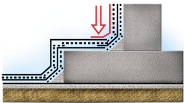
Выполните наплавление второго слоя гидроизоляционной мембраны в зоне внешнего угла по вертикальным ограждающим конструкциям.
