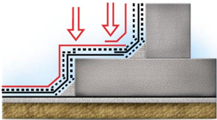
Выполните наплавление второго слоя вертикальной гидроизоляционной мембранны в зоне внутреннего угла, сначала по фундаментной плите. Затем наплавьте второй слой гидроизоляционной мембранны по всему периметру сооружения по фундаментной плите.
