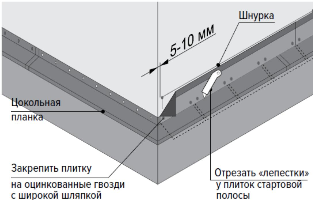
Первый ряд плитки крепится поверх стартовой полосы, вровень с цоколем на 8 гвоздей или на 5 гвоздей, в зависимости от ветровой нагрузки. Если дом находится на открытом месте, где встречаются сильные ветра, то монтаж нужно осуществлять на 8 гвоздей..
