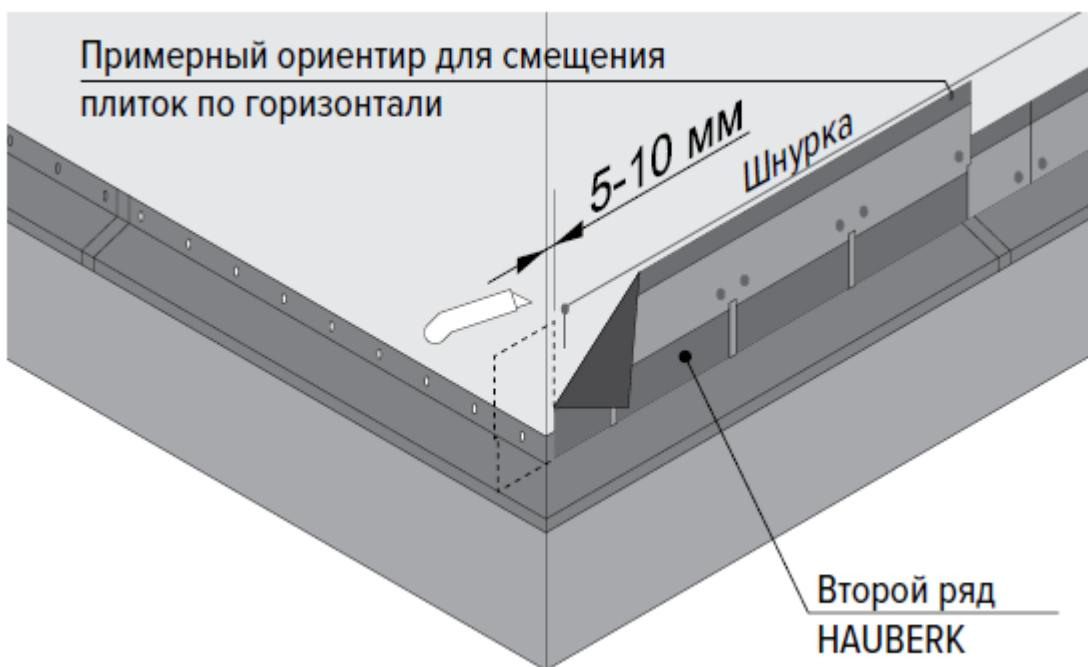
Следующие ряды фасадной плитки укладываются со смещением от предыдущего на половину лепестка (примерным ориентиром служат насечки, нанесенные на верх плитки). Клеевые
