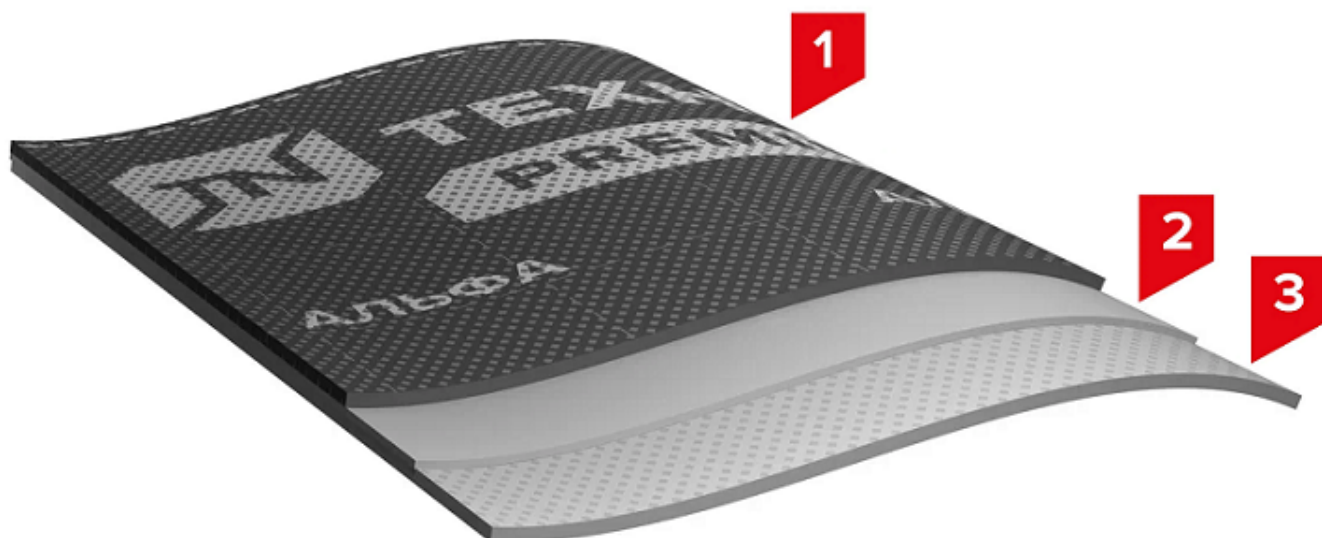
Рис. 1. Схема устройства трехслойной диффузионной мембраны: 1 – нетканый полипропилен (спанбонд); 2 – микропористый функциональный слой; 3 – нетканый полипропилен (спанбонд)
