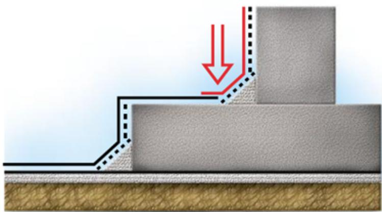
Примерку первого слоя вертикальной гидроизоляционной мембраны в месте перехода «фундаментная плита — вертикальная ограждающая конструкция» проведите таким образом, чтобы нахлест мембранны на фундаментную плиту составлял 150 мм. В месте перехода рулона на фундаментную плиту разрежьте рулон по диагонали.
