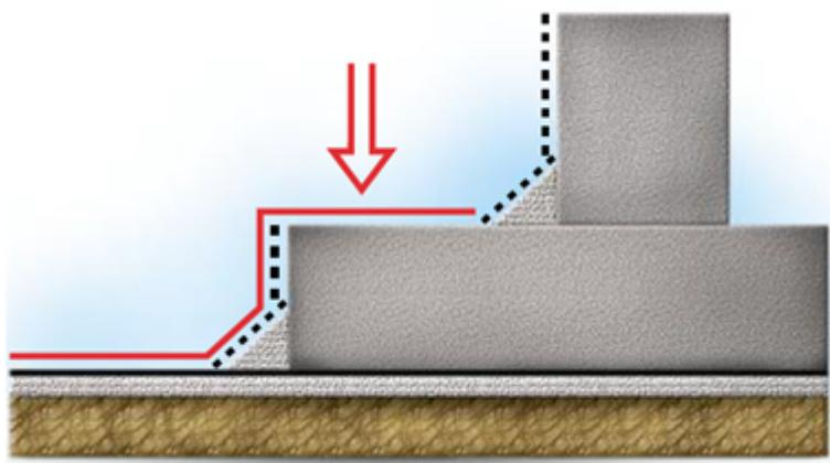
Примерку первого слоя вертикальной гидроизоляционной мембранны проведите таким образом, чтобы один край рулона точно совпадал с внутренним углом по фундаментной плите. В месте перехода рулона на бетонную подготовку разрез выполнайте по диагонали.
