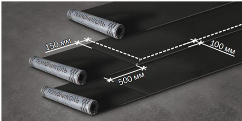
В месте формирования Т-образных швов подрежьте угол рулона, находящийся между верхним и нижним рулонами. Подрезка угла позволит повысить качество сварного соединения, избежав мест непроплава.
