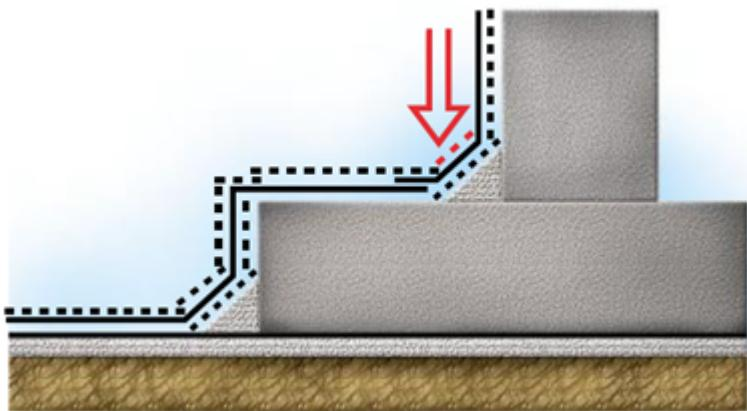
Подготовьте элемент усиления в месте перехода с горизонтальной поверхности фундаментной плиты на вертикальные ограждающие конструкции.
