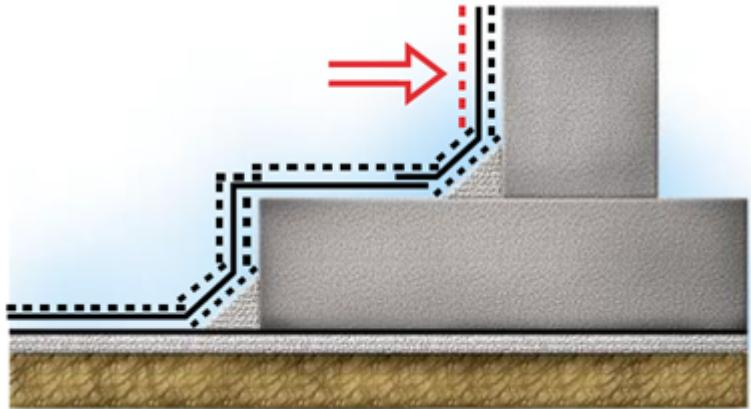
Подготовьте и наплавьте элемент усиления на вертикальных ограждающих конструкциях.
