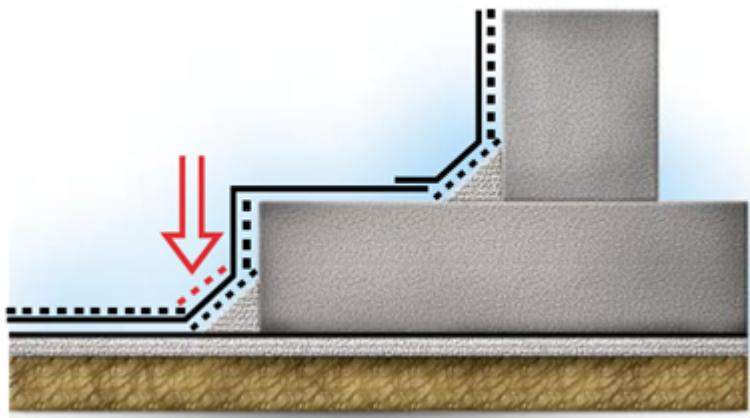
Подготовьте элемент усиления в зоне перехода с бетонной подготовки на вертикальную часть фундаментной плиты.
