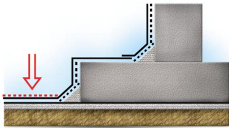
После устройства первого слоя вертикальной гидроизоляционной мембраны выполните второй слой усиления внутреннего угла.
