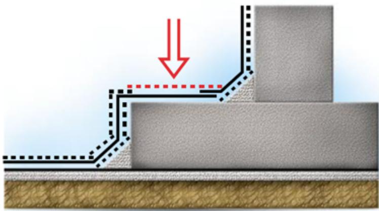
Подготовьте и наплавьте элемент усиления на горизонтальной поверхности фундаментной плиты. В месте заведения на вертикальную часть подрежьте элемент усиления, чтобы не допустить образования складок.
