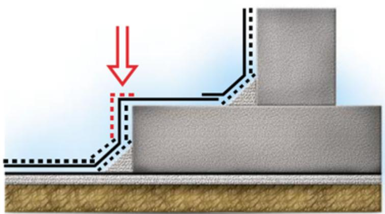
Подготовьте и наплавьте элемент усиления на вертикальной части фундаментной плиты.
