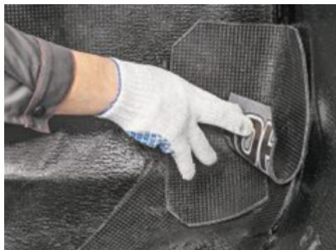
Подрезанные участки элемента усиления наплавьте друг на друга без образования складок.
