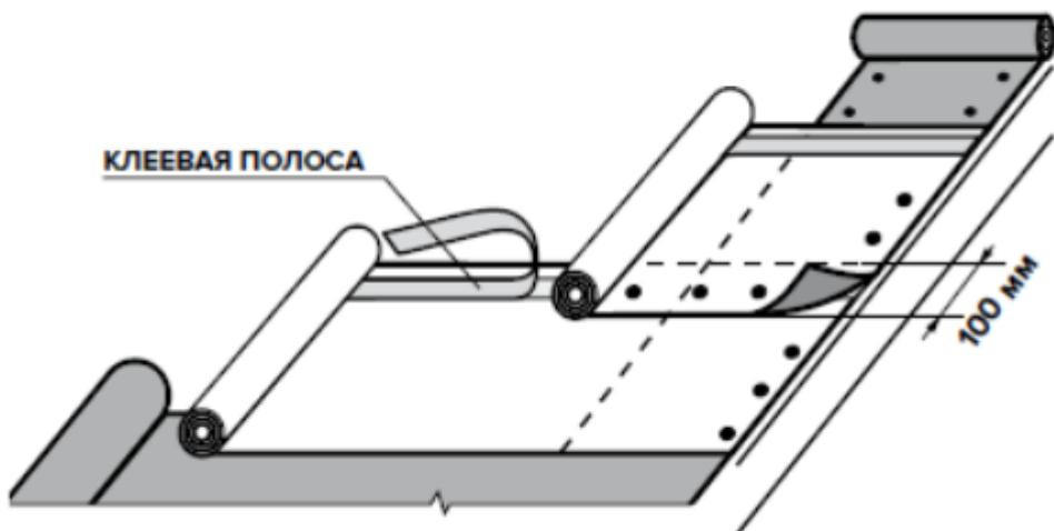
Пленка выполнена только по плоскости, которая образует продольный перехлест на ширину 100 мм
