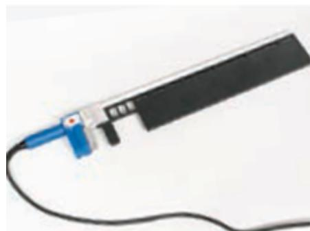
Зафиксируйте соединяемые концы гидрошпонок в кондукторе.
