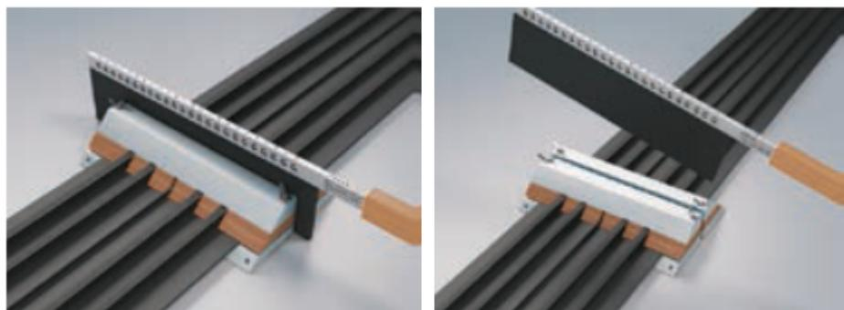
После этого кондуктор следует раздвинуть, вынуть нагревательный элемент и сдвинуть снова. Оплавленные края шпонки при этом сомкнутся и произойдёт их сплавление.
