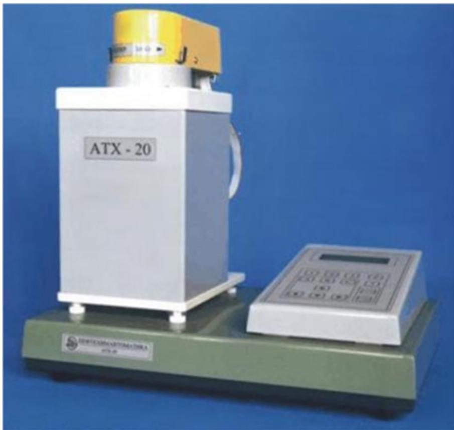
Температура хрупкости по Фраасу – это температура, при которой модуль упругости битума при длительности нагружения 11 секунд для всех одинаков и равен 11 МПа.
