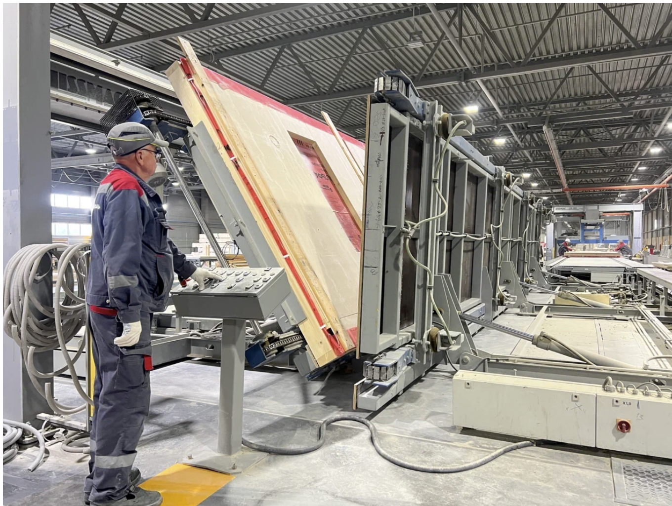
Рис.2. Сборка стеновой панели на заводе МКД в городе Семёнове
