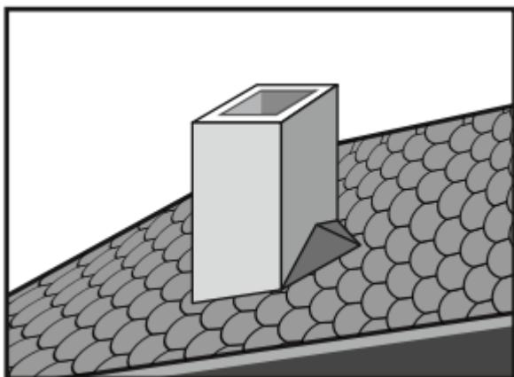
Для заведения на вертикальную поверхность используют Рулонную Черепицу. Выкройки для заведения наверх следует укладывать внахлест не менее 200 мм на поверхность покрытия и с минимальным нахлестом 300 мм на заводимую поверхность. Размер галтели уточнить по месту.
