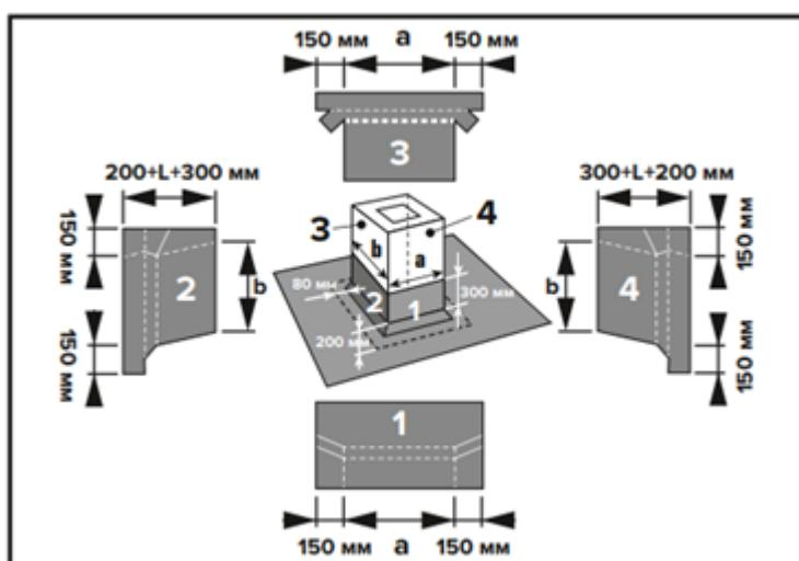
Полученные выкройкигибаются или надрезаются в определенных местах. Первоначально монтируется лицевая выкройка. Затем монтируется левая и правая выкройки. В последнюю очередь монтируется тыльная выкройка. При монтаже необходимо соблюдать принцип каскадности воды. Места сопряжения следует проклеить битумной мастикой ФИКСЕР на величину 100 мм.
