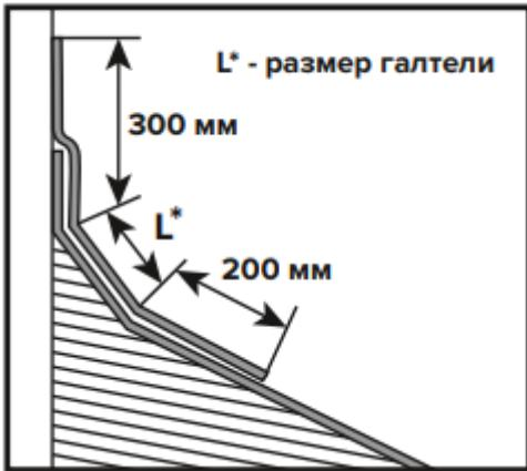
Для герметизации дымовых и вентиляционных труб делают выкройку из Рулонной Черепицы либо из металла с антисорбционным покрытием.
