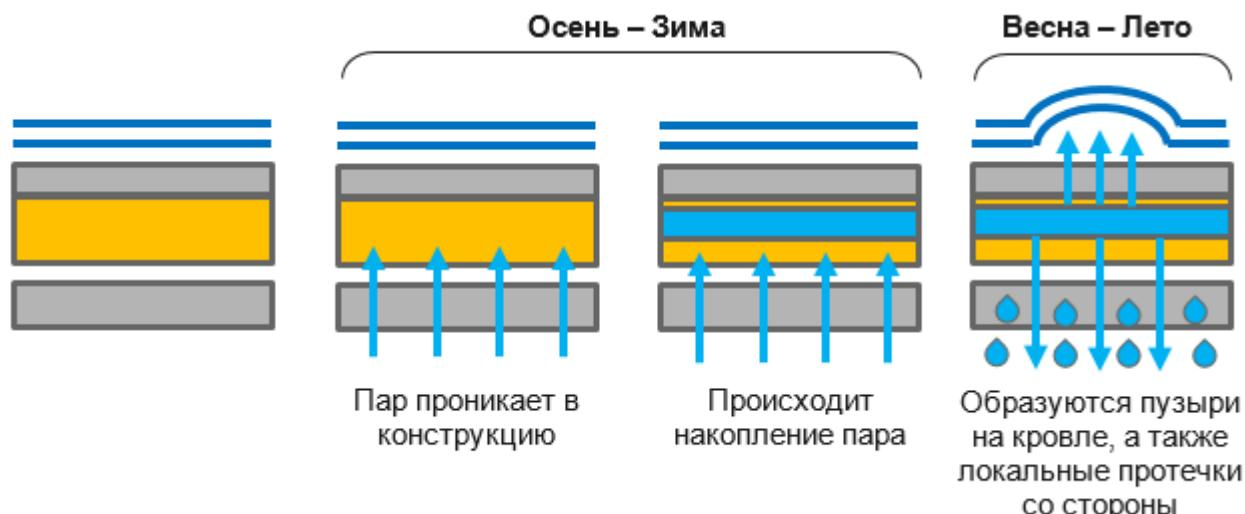
При устройстве инверсионных кровель функцию пароизоляции выполняет водоизоляционный слой, который укладывается ниже теплоизоляции.
