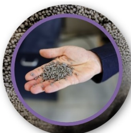
Вторичные гранулы ПНД (Полиэтилен низкого давления)
