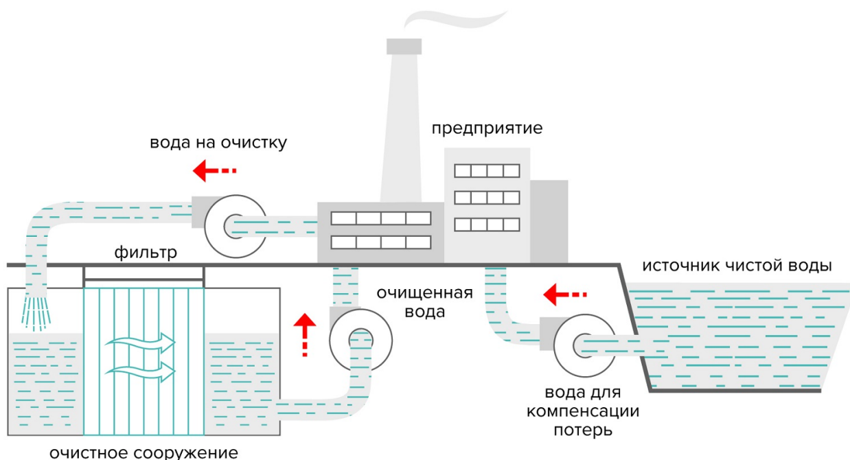
Схема замкнутого цикла водопользования
