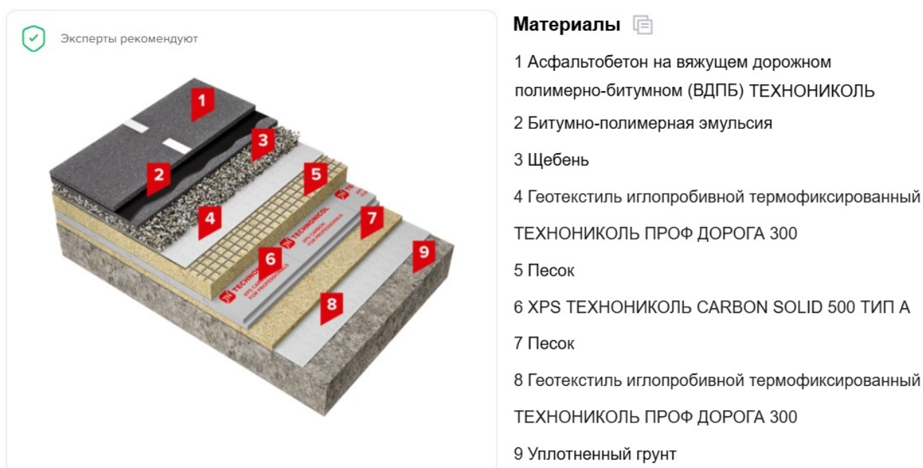
Рисунок 1. Система ТН-ДОРОГА Термо, которую рекомендуется применять при проектировании и строительстве автомобильных дорог в условиях ММГ
