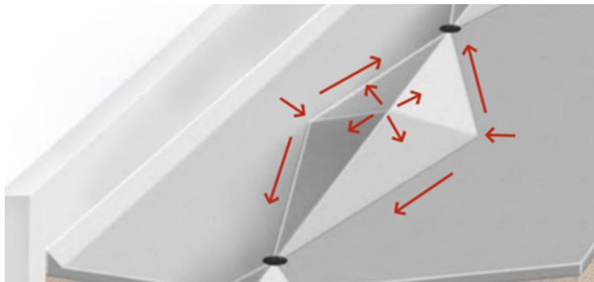
**Важно! Уклонообразующий слой может быть сформирован несущими плитами покрытия при проектировании крыши.**
