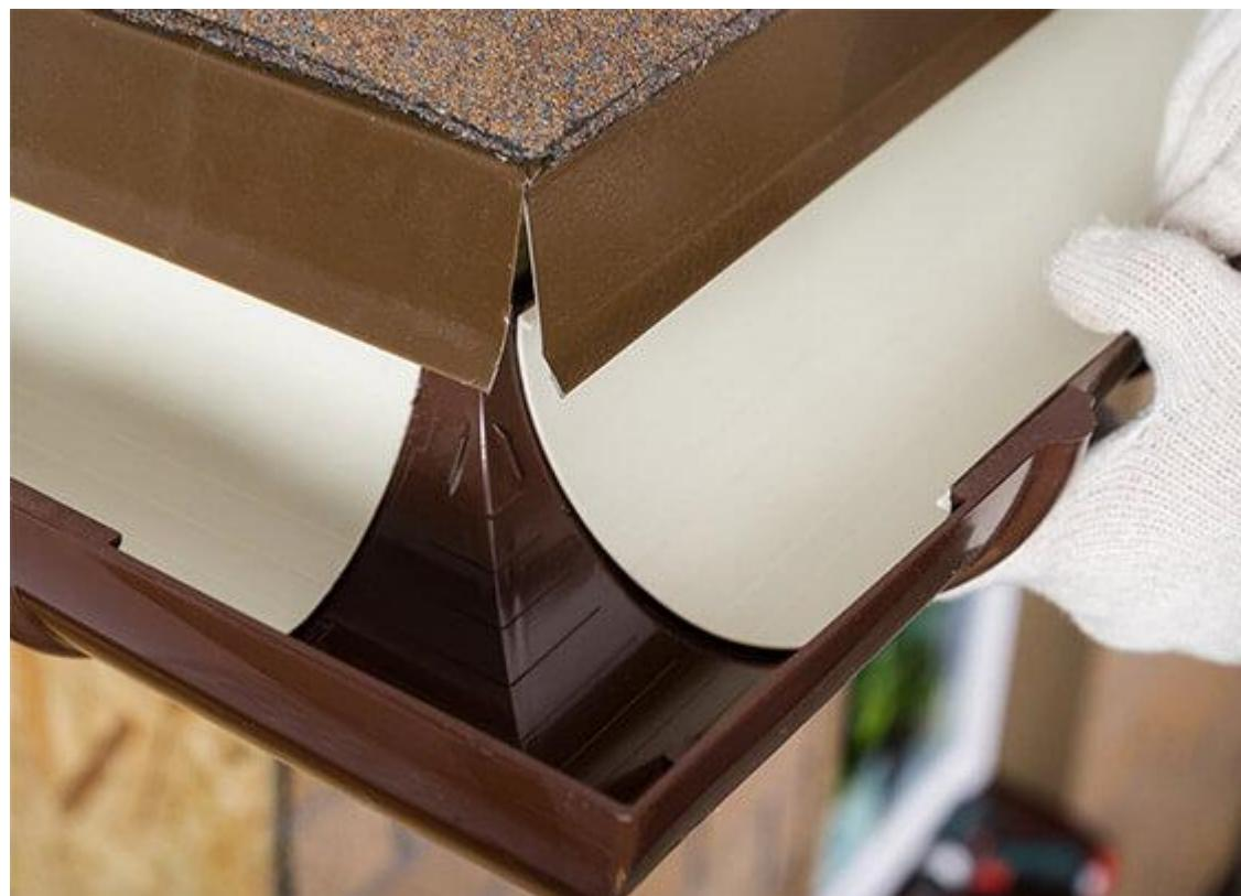
Если угол поворота кровли не равен  $90^\circ$ , используйте угол жёлоба регулируемый, который состоит из двух элементов и подрезается по месту по отметкам угла поворота, заранее нанесенным на заводе-изготовителе. Соединение дополнительно герметизируйте.
