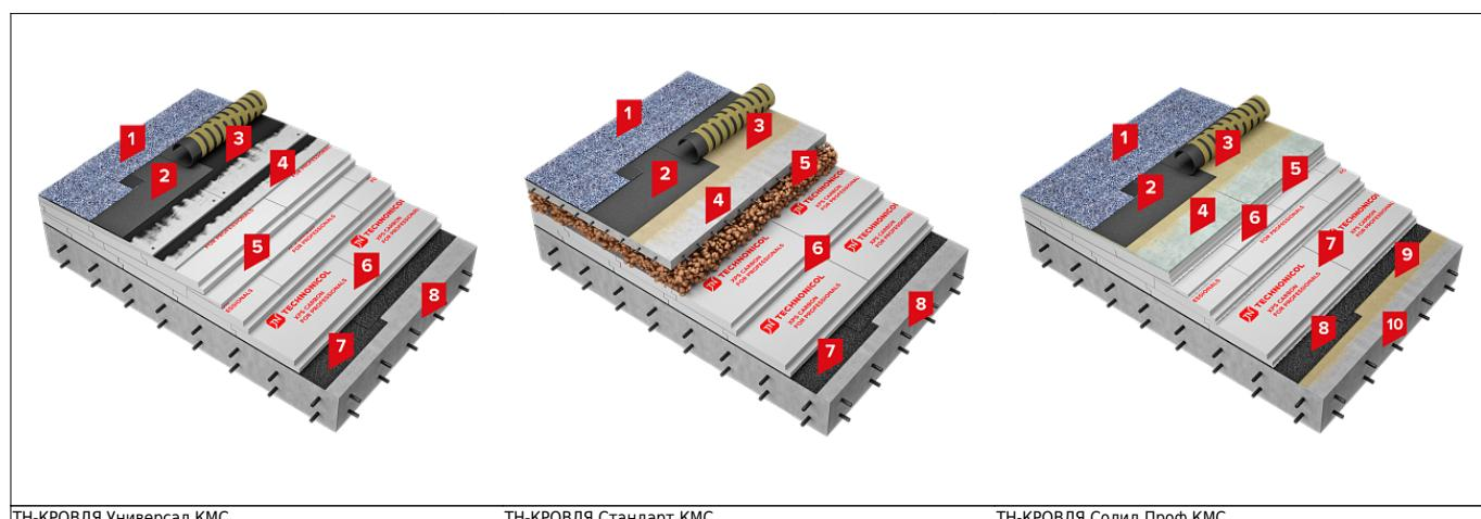
Данные варианты отличаются наличием клиновидной изоляции, подготовкой основания под наплавление гидроизоляции. Универсал, Стандарт используют как основание — стяжку. В системе Стандарт это стяжка по разуклонке из керамзитового гравия, а в системе Универсал сборная стяжка по плитам клиновидной теплоизоляции. Систему Солид Проф отличает то, что в ней применяют плиты Ц-XPS, которые сразу покрыты цементно-полимерным составом (то есть возможно сразу выполнять наплавление на плиты).
