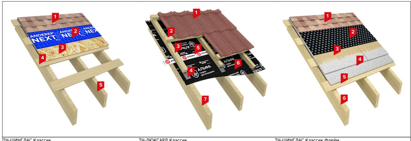
Решения ТН-ШИНГЛАС Классик и ТН-ЛЮКСАРД Классик отличаются финишным покрытием, а также подготовкой основания под гидроизоляцию. В системе Шинглас применяют сплошной настил и подкладочный ковер. В системе Люксард используют супер диффузионную мембрану. Выбор между этими решениями выбор между материалами SHINGLAS и LUXARD.
