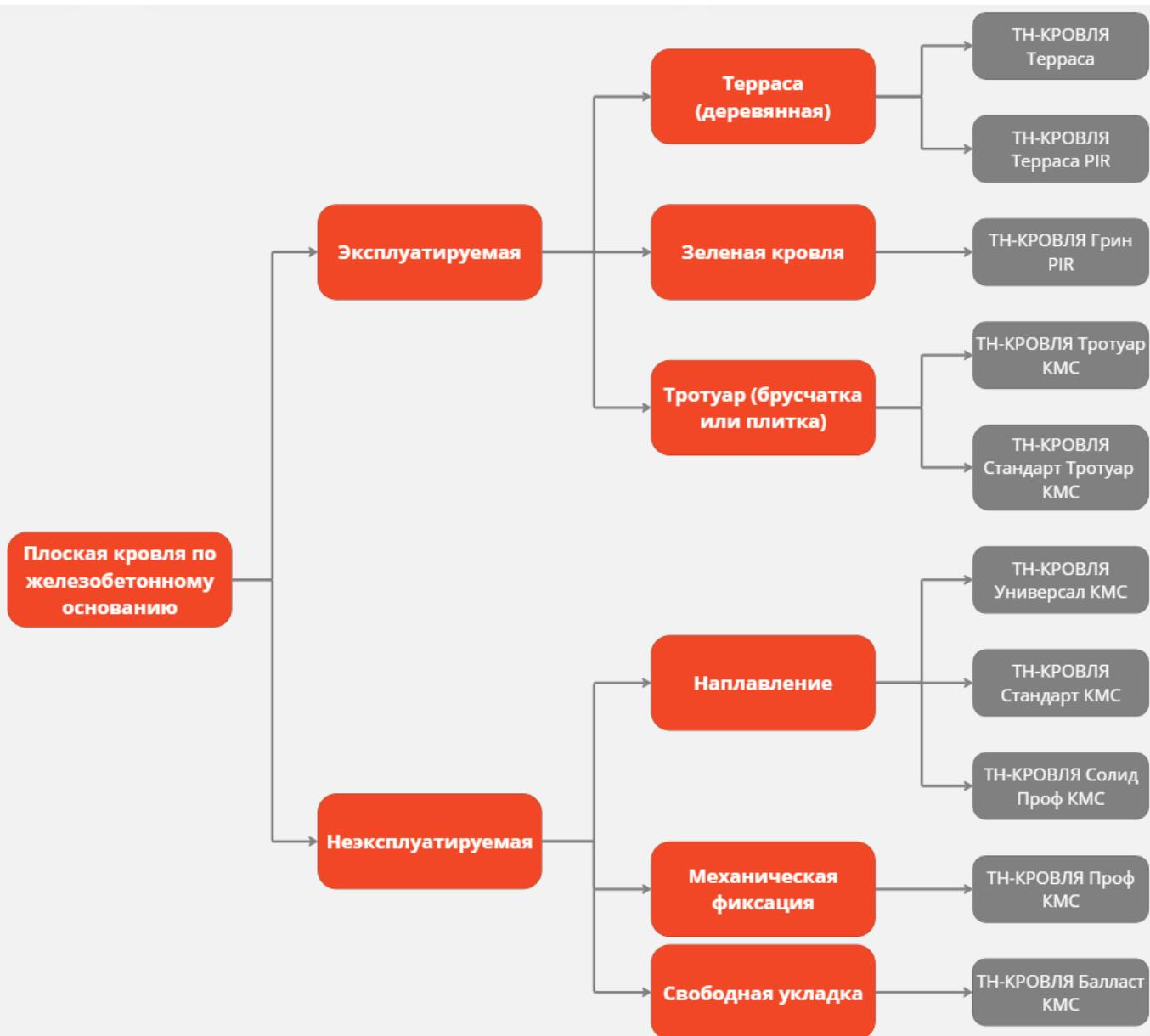
При выборе решения стоит учитывать то, какие подрядчики есть в вашем регионе. Для работы с полимерными мембранами требуется специальное оборудование, квалификация, для наплавления рулонных материалов нужно обладать навыками работы с горелкой.
