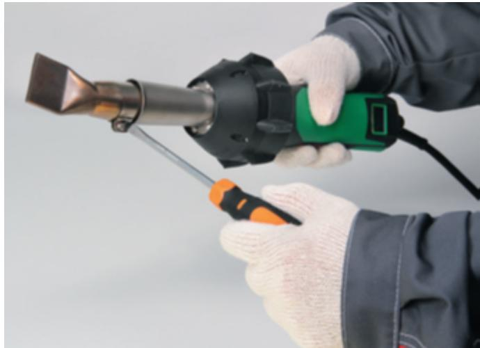
Для включения аппарата нажмите кнопку включения и удерживайте ее несколько секунд. Для сварки мембранны LOGICBASE V-SL выберите температуру 400–510 °C в зависимости от погодных условий и скорости сварки. После включения фена на нагрев подождите 2–3 минуты до прогрева воздуха.
