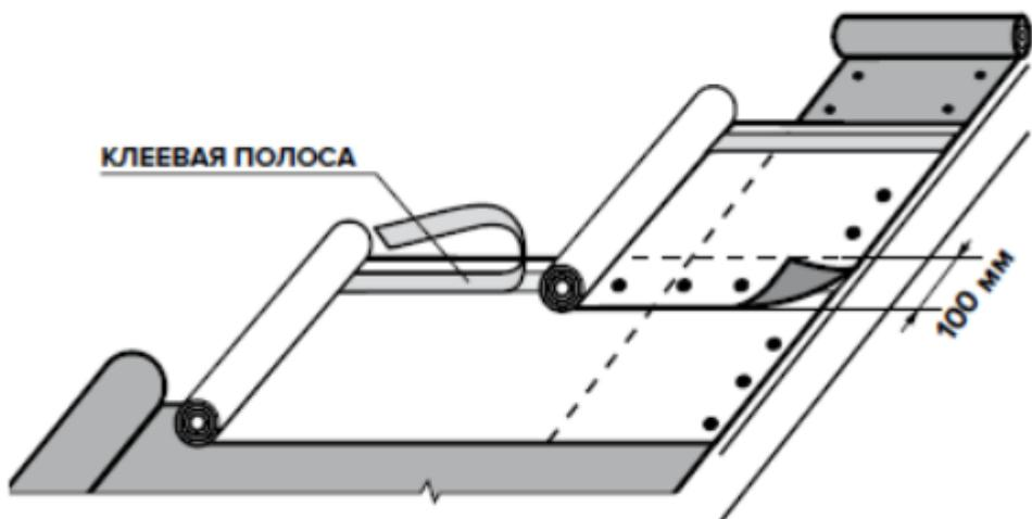
Плёнка выполнена только по плоскости, которая образует продольный перехлест на ширину 100 мм
