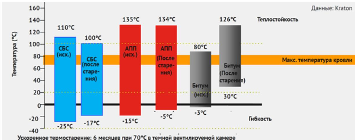
В соответствии с ГОСТ 32806-2014 «Черепица битумная. Общие технические условия» требования к теплостойкости битумной черепицы не ниже +100°C, требования EN 544:2011 – не ниже +90°C.
