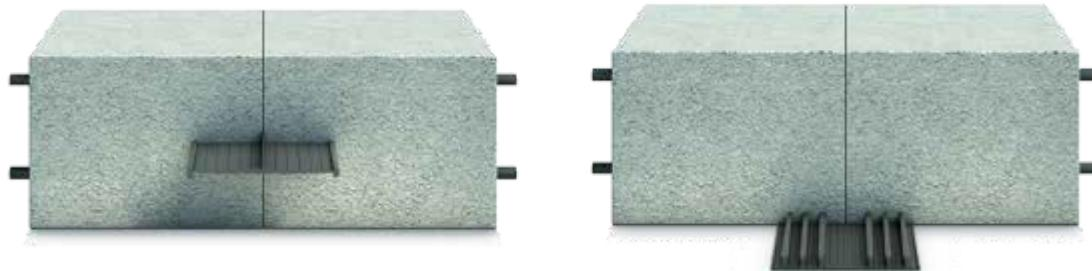
Внутренние шпонки защищены слоем бетона от внешних воздействий и могут выдерживать давление воды с любой стороны, боковые же должны прижиматься давлением воды к бетону.
