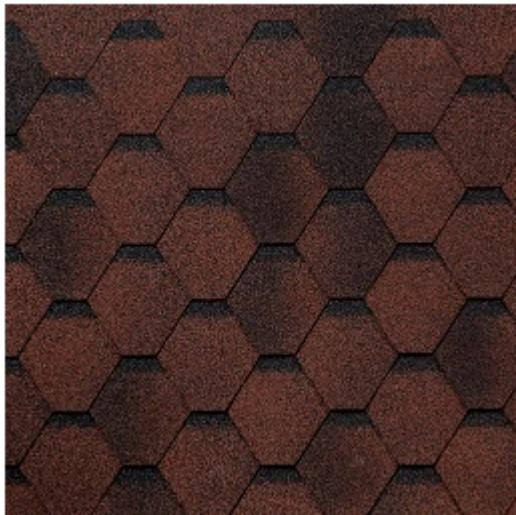
Гибкая черепица TILERCAT – это штучный, битумосодержащий кровельный материал. Изготавливается нарезанием листов из рулонного материала, получаемого путем пропитки и покрытия стекловолокнистой основы битумным вяжущим, с последующим нанесением различных видов защитных покрытий.
