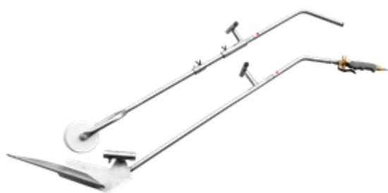
Горелка разработана для сплавления нахлестов битумно-полимерных мембран. Предназначена только для сварки полотнищ в местах стыков. Горелка сконструирована таким образом, что кровельщик может комфортно осуществлять наплавление стоя прямо во весь рост, не сгибаясь и не работая в неудобных положениях. Благодаря системе безопасности, приподнимающей край материала, предотвращается самозатухание пламени и происходит качественное проплавление края материала.
