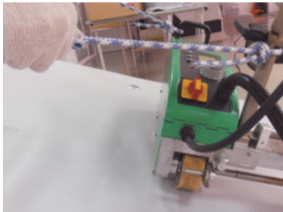
Следите за тем, чтобы прижимной ролик автоматического сварочного аппарата не выходил за пределы сформированного нахлеста, а кончик сопла выступал из наружной границы шва на **2-3 мм.**
