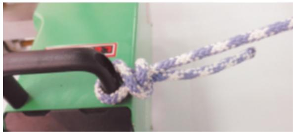
Крепление тросов производите за транспортировочные рукоятки аппарата, в противном случае сварочный аппарат не будет иметь точки опоры за счет смещенного центра тяжести, что может привести к отсутствию прижима, пробуксовке аппарата во время движения или его опрокидыванию.
