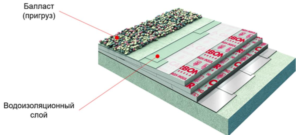
Балластные крыши могут применяться как при новом строительстве, так и при реконструкции.
