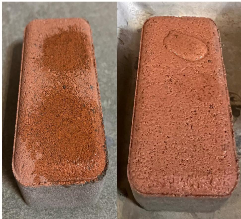
Гидрофобизирующая пропитка Лотус Т - представляет собой готовую к использованию акриловую водную эмульсию, модифицированную гидрофобизирующими добавками
