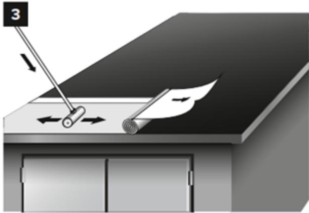
1. Рулон следующего ряда укладывают с нахлестом 100 мм. В месте бокового нахлеста удаляют антиадгезионную пленку. Для формирования торцевого нахлеста в конце верхнего рулона отрезают уголок материала размером 150 мм и 100 мм.
