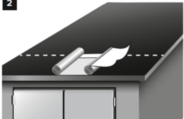
1. С одной стороны рулона вытянуть адгезионную пленку и одновременно прижать материал к основанию. После приклейки материал прикатывают валиком или щеткой.
