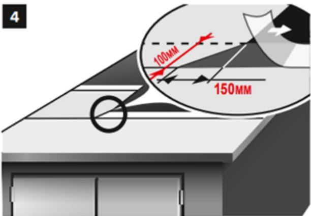
1. На место формирования торцевого нахлеста нанести слой битумной мастики ФИКСЕР. Место склейки дополнительно прокатать роликом. Ширина торцевого нахлеста составляет 150 мм.
