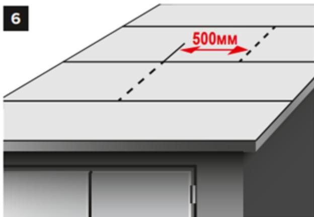
Уклон основания не должен превышать 10%. Допускается укладка материала на основание с уклоном до 25% при дополнительном механическом креплении в швах материала.
