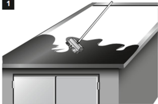
1. Материал укладывают параллельно карнизному свесу. Укладку начинают снизу вверх по уклону от карнизного свеса, боковым нахлестом выше по уклону. Примерить материал по месту. Скатать рулон к середине, надрезать защитную пленку.
