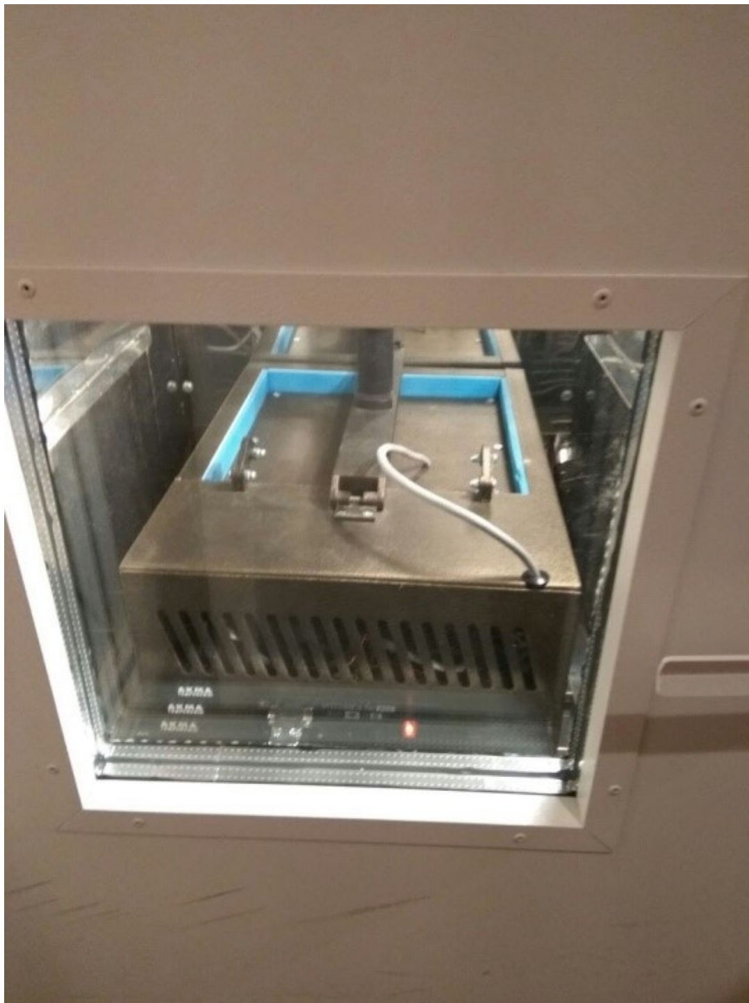
Рис. 2 Испытания на измерителе теплопроводности ИТП-МГ4 «250», помещенном в климатическую камеру
