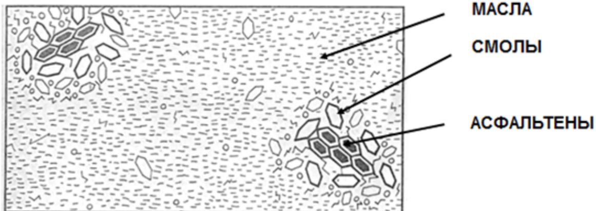
Для производства рулонных кровельных и гидроизоляционных материалов используют искусственные битумы, полученные при переработке нефти.
