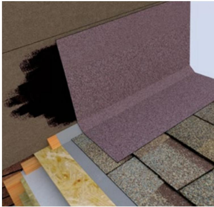
3. Механически закрепить металлический фартук. Произвести герметизацию фартука силиконовым, тиоколовым или полиуретановым герметиком.
