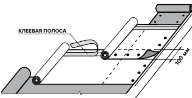
При угле наклона кровли > 18° ширина перехлеста составляет 100 мм.
