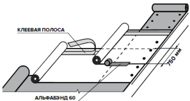
При угле наклона кровли от 12° до 18° ширина перехлеста составляет 750 мм, перехлест фиксируется самоклеящейся односторонней лентой АЛЬФАБЕНД 60.
