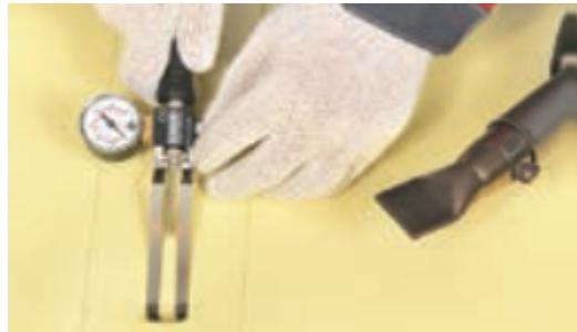
**ВАЖНО! Будьте предельно осторожны при вводе иглы, она не должна повредить обратную сторону воздушного канала**
